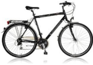
**Das Trekkingrad:** Im Gegensatz zum City- oder Stadtrad sind Trekkingräder für mittlere und längere Touren ausgerüstet. Meth Ritzel sorgen für eine Fülle an Gängen sowie vermehrte Federung für mehr Komfort im Sattel und bei der Beförderung von Gepäck.
